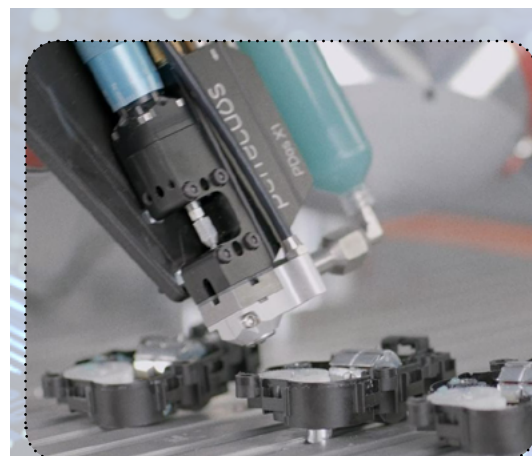
Bild2: Mit 300 Hz Taktfrequenz wird eine hohe Dosierfrequenz bei einer Entfernung von 50 mm bei horizontalen und Überkopfaufnahmen erzielt (Bild: perfectdos GmbH)
